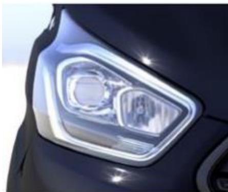
Halogena projektorska svjetla sa LED DTL i statičkim svjetlima skretanja
